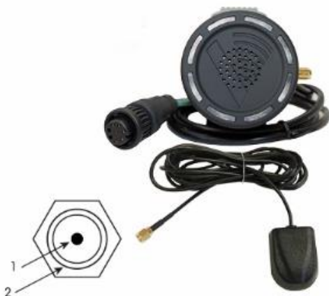
Abbildung 12: Anschluss und Pinbelegung der GPS-Antenne
