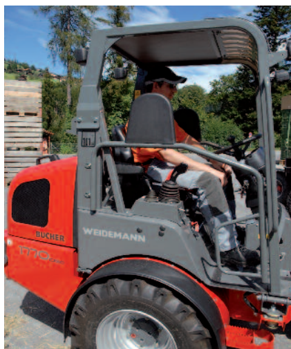
Dal 01.01.2010, i nuovi caricatori compatti devono avere un dispositivo di protezione e un dispositivo di trattenuta del conducente. A dipendenza del loro impiego, anche quelli più vecchi devono essere adattati.
