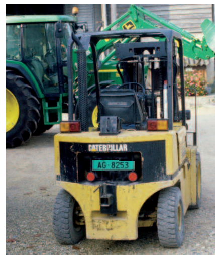
Su strade pubbliche, i carrelli elevatori devono essere immatricolati o avere un permesso speciale. È obbligatorio un sistema di trattenuta del conducente
