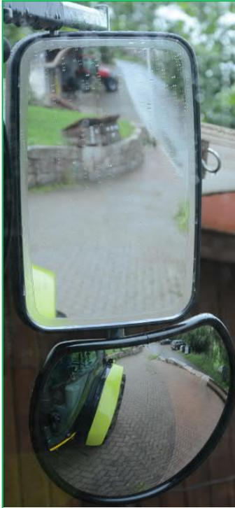
Bei älteren Traktoren fehlen die Zusatzspiegel. Das kann gefährlich werden! "Original" sind heute praktisch alle neuen Traktoren mit Haupt- und Zusatzspiegeln oder Doppelspiegeln ausgerüstet.
