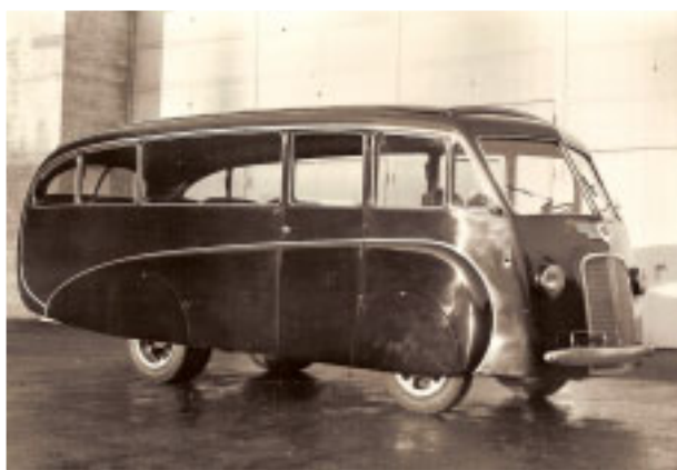
International-Stromlinienbus 1937/38, der Radeinschlag war dürftig.
